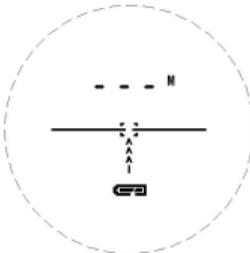
当产品中的电池电压过低时，低电图案会一直显示，提醒更换电池。
