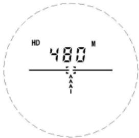
外侧显示实测距离，倾斜角及水平距离
